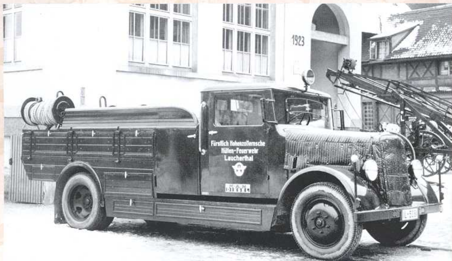
Eigenaufbau: Der Mannschafts- und Gerätewagen der Fürstlich Hohenzollernschen Hüttenwerke auf einem MAN-Fahrgestell der Baureihe „E“.
